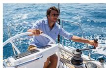
**SI** I winch sono stati arretrati ulteriormente e ora sono a portata di mano del timoniere
